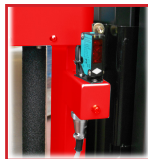
Fotocelula para detectar la altura del palet Photoeye to detect pallet height
